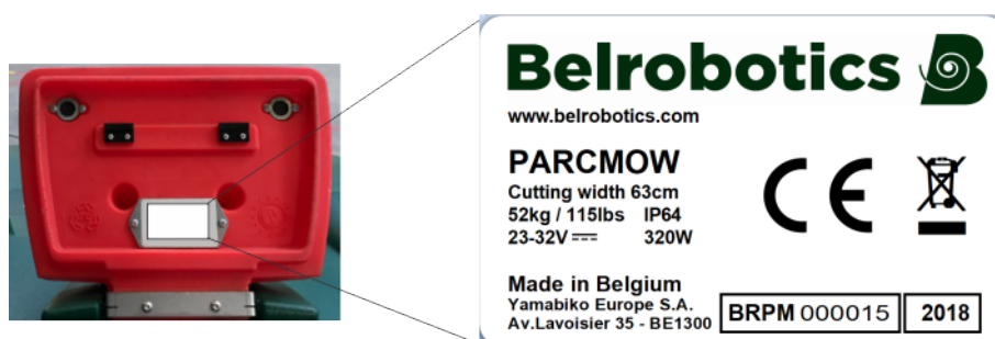
Afbeelding 5: Identificatielabel aan de binnenkant van de STOP-knop/klep
